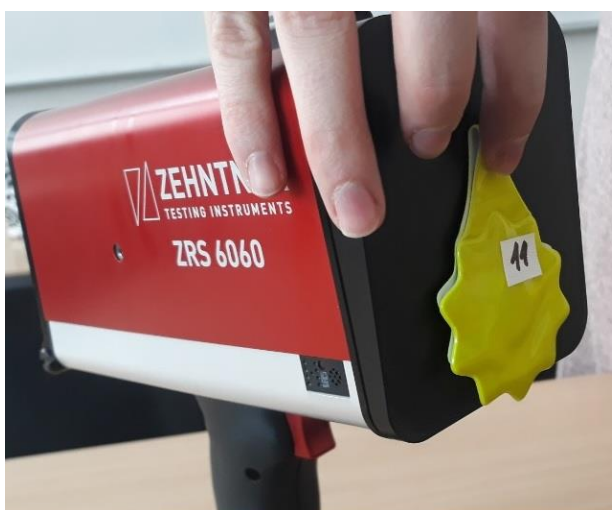
Obr. 15 - Měření retroreflexe retroreflektometrem Zehntner ZRS 6060 [Zdroj: vlastní zpracování]
