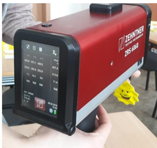
Obr. 15 - Měření retroreflexe retroreflektometrem Zehntner ZRS 6060 [Zdroj: vlastní zpracování]
