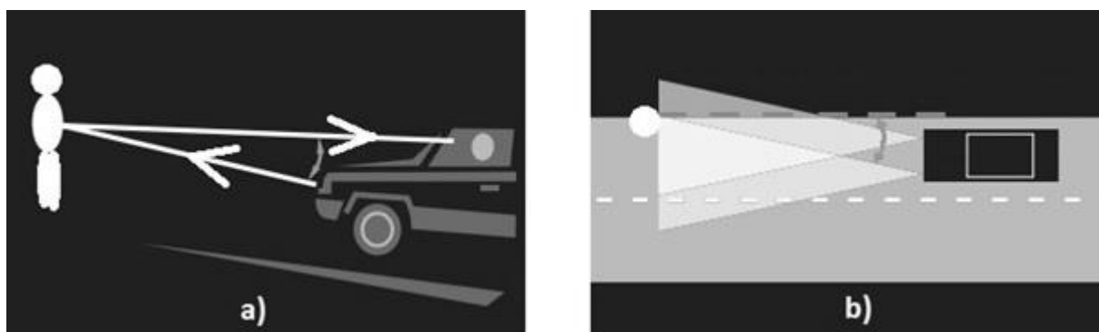
Obr. 6 - a) úhel pozorování, b) úhel dopadu [23]
