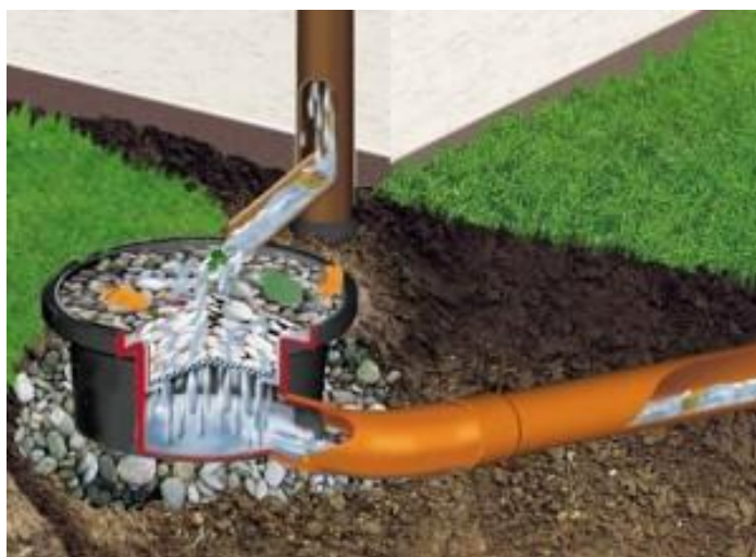
Obrázek 6: Filtrační hrnec (Dvořáková, 2007)
