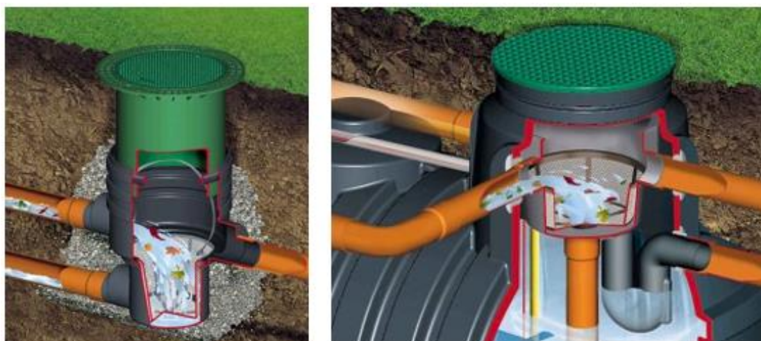
Obrázek 8: Filtrační koš umístěný v tělese filtru (vlevo) a v akumulaci nádrži (vpravo) (Dvořáková, 2007)
