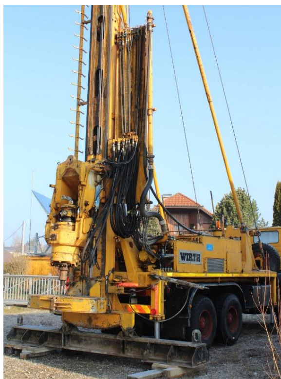
Obr. 2.11 Vrtná souprava Wirth B-3A [21].
