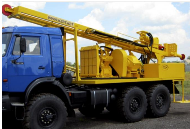
Obr. 2.10 Vrtná souprava URB-2A-2 [19].
