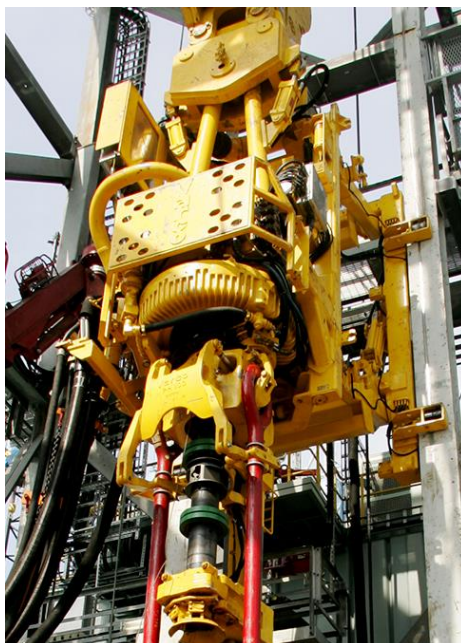
Obr. 2.4 Top Drive TDS-8SA společnosti National-Oilwell Varco, Inc. [14].
