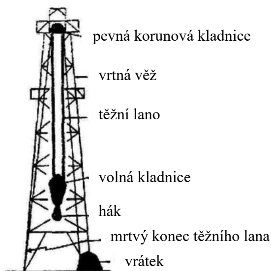
Obr. 2.1 Schematické znázornění vrtné věže s hlavními částmi kladkostroje [12].
