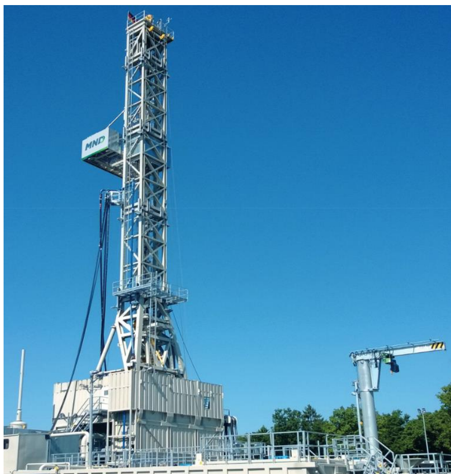
Obr. 2.13 Vrtná souprava Bentec 250 [26].
