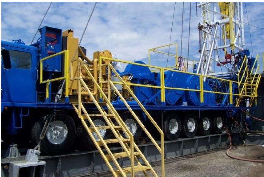
Obr. 2.12 Vrtná souprava IDECO řady BIR [25].
