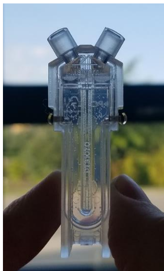
Obrázek 17: Ukázka degradace vzorku liposomů při měření zeta potenciálu.
