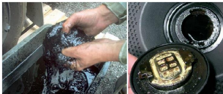
Obr. 2-23 - interakce glykolu a motorového oleje [45]
