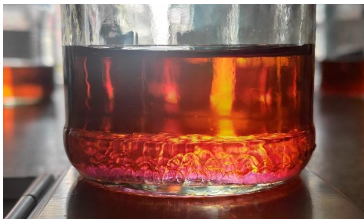
Obr. 5-27 - interakce glykolu s olejem [vlastní]
