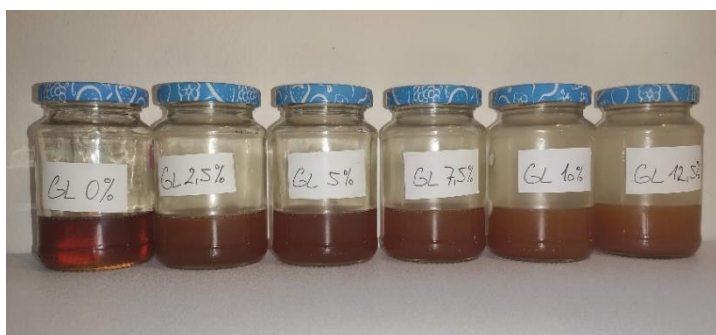
Obr. 5-28 - změna zabarvení a viskozity směsí oleje a glykolu [vlastní]
