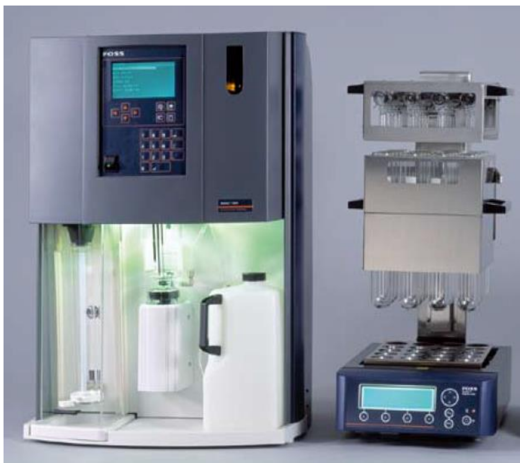
Obr. 23 Přístroj Kjeltec™ 2300 (vlevo) pro automatickou destilaci a kolorimetrickou titrací analýzy vzorků metodou kjeldahlizace. Na obrázku je také umístěno topné hnízdo Tecator™ Digester 20 Auto Lift, kde probíhá mineralizace vzorku v kyselině sírové (Euritmic Grup, převzato).
