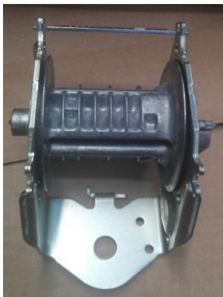
Obr. 11 Sestava držáku navijáku a cívky po operaci ohýbání držáku navijáku a lisování fixačního plechu
