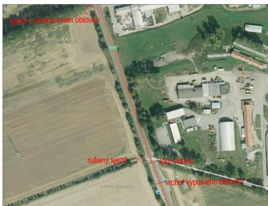
Obrázek 5: Nahrazení rušeného sjezdu
