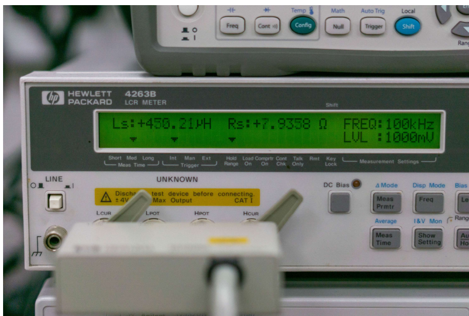
Obrázek 34 – Měření indukčnosti primárního vinutí
