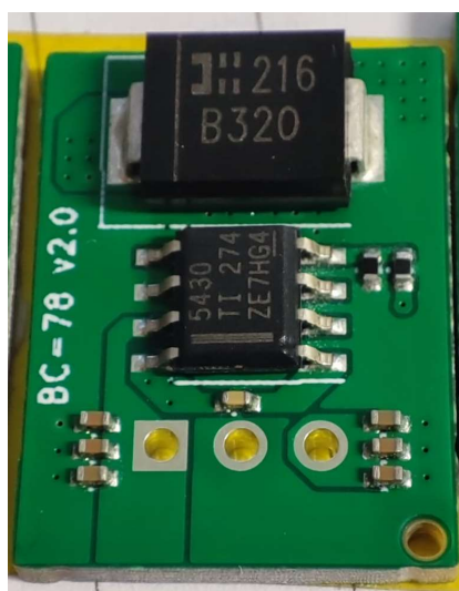
Obrázek 4 – BUCK regulátor na PCB řízený obvodem TPS5430
