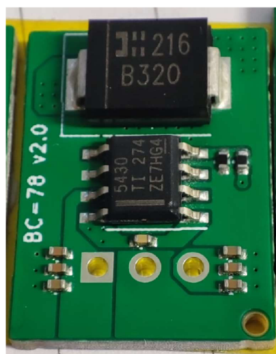
Obrázek 4 – BUCK regulátor na PCB řízený obvodem TPS5430
