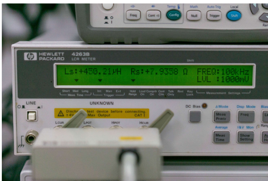
Obrázek 34 – Měření indukčnosti primárního vinutí
