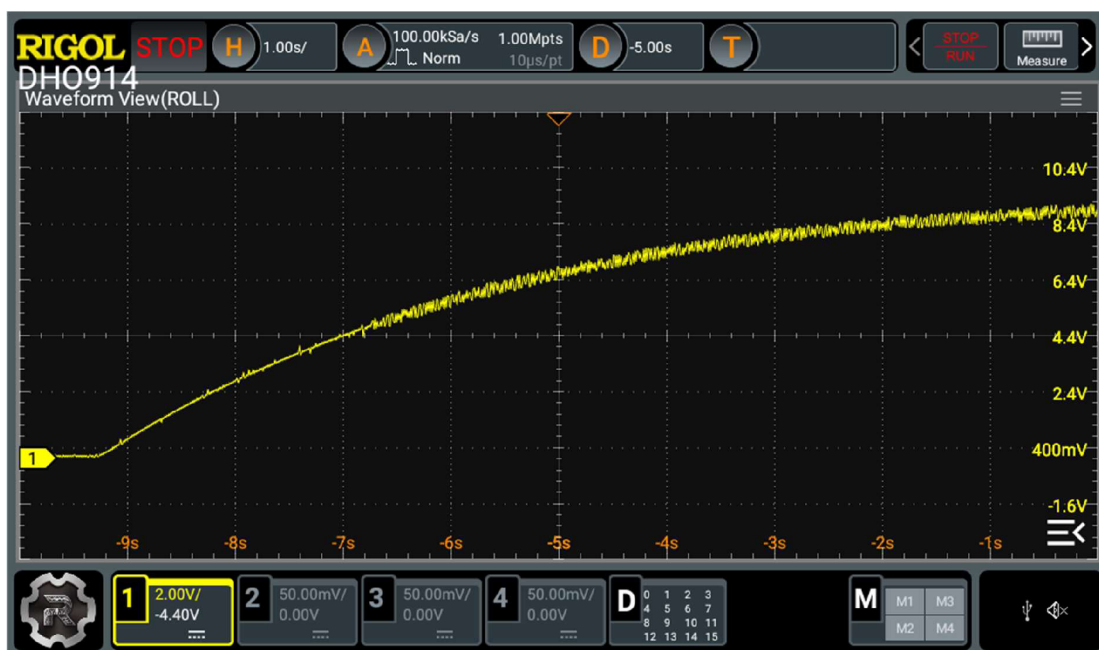
Obrázek 38 – Měření napětí na gate MOSFETu sofstartu
