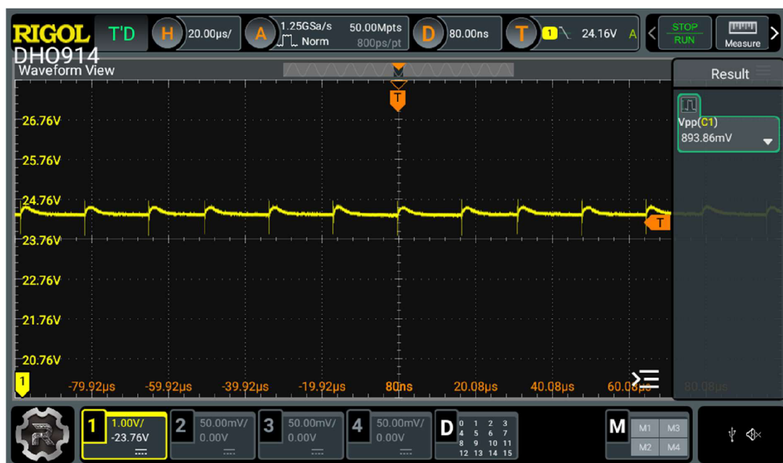
Obrázek 36 – Měření zvlnění nového transformátoru
