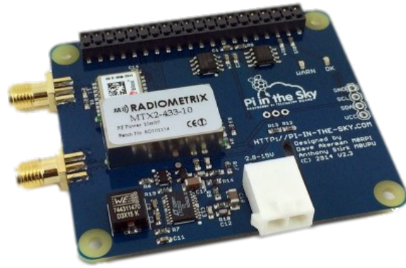
Obrázek 3.7: PITS+ modul pro počítače Raspberry Pi verzí A+, B+, V2 B, převzato z [46].
