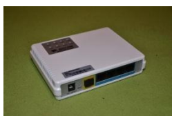
Obr.34- Optický media konvertor BDCOM použitý při stavbě Zdroj: archiv Eldata
