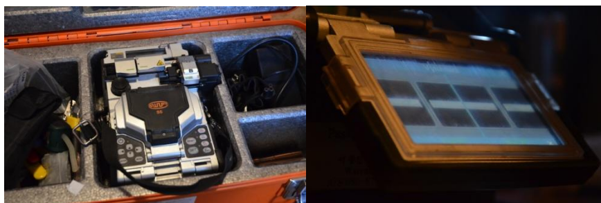
Obr.45- Použitá svářečka Swift S5 - Příklad provádí proces svařování Zdroj: archiv Eldata (fotografoval J.Prek)
