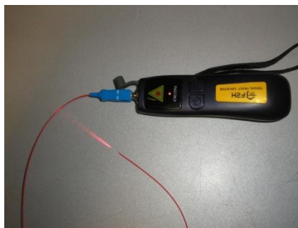
Obr.51- Visual fault locator- přístroj pro jednoduché přímé měření Zdroj: archiv Eldata (fotografoval J.Prek)
