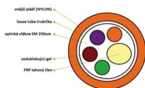
Obr.37- 4 vláknový optický kabel Airblown Zdroj: www.alternetivo.cz
