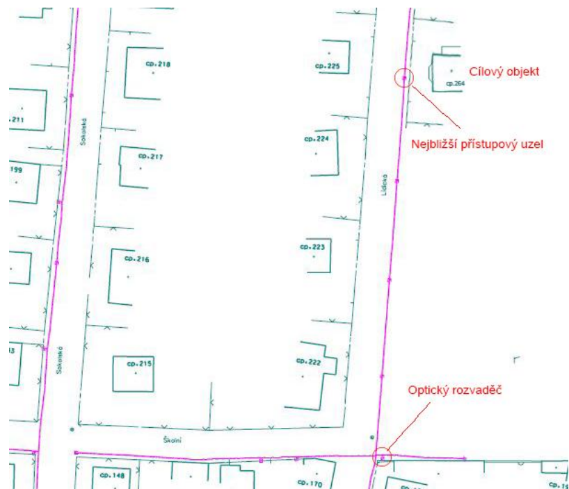
Obr.30- Ukázka vedení optických kabelů od rozvaděče až k poslednímu uzlu před objektem Zdroj: archiv Eldata
