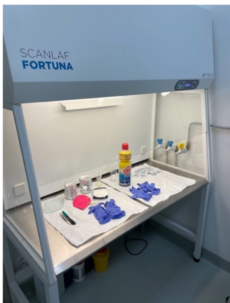
Obr. 5 Laminární box pro zakládání testů klíčivosti, foto.: K. Lipanská, 28.2.2023
