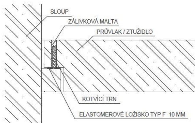
37 uložení průvlaku / ztužidla
