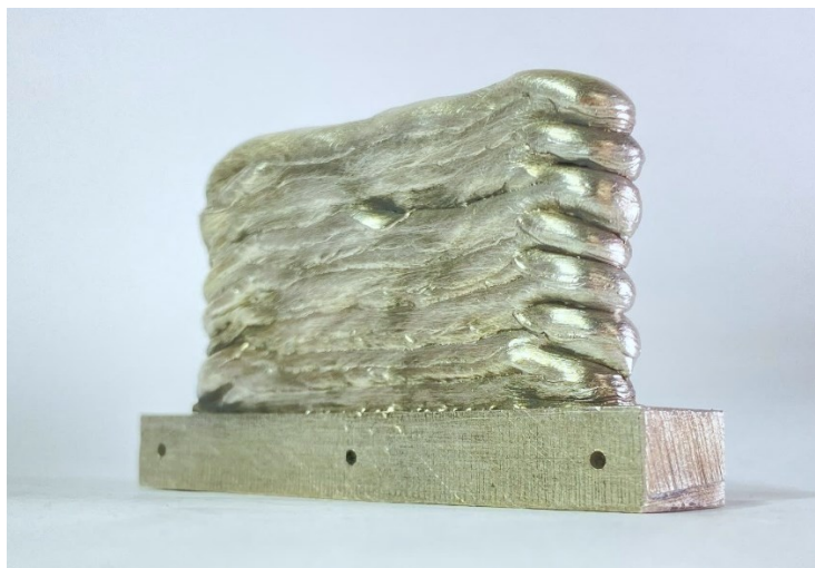
Obr. 7-22 Tenkostěnný vzorek vyrobený s částečným předehřevem
