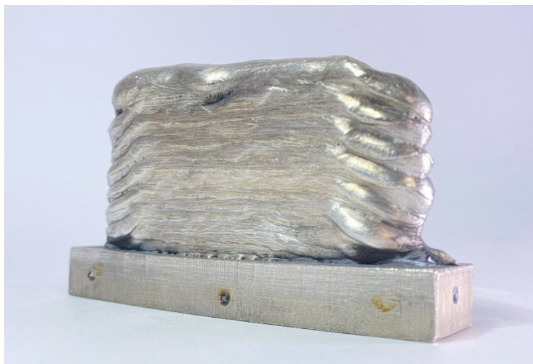
Obr. 7-20 Tenkostěnný vzorek vyrobený s konstantní teplotou předehřevu
