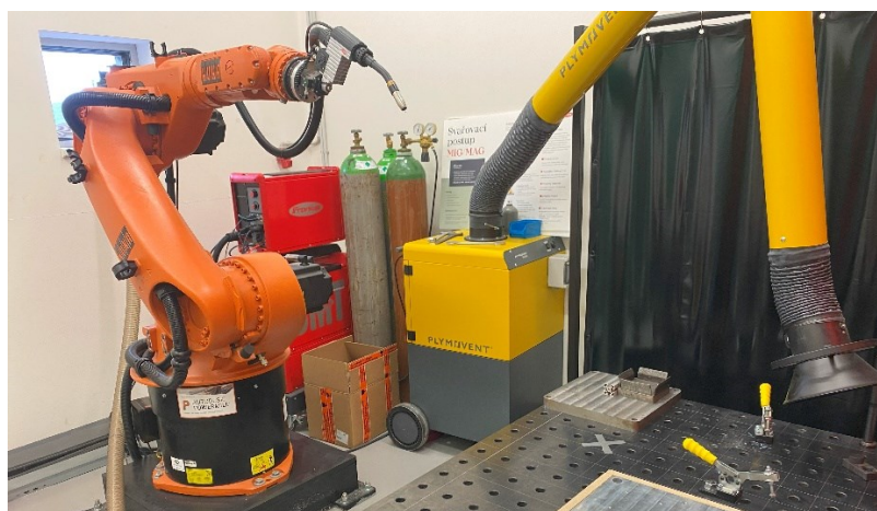
Obr. 6-2 Robotické rameno Kuka vybavené Svařovacím zdrojem Fronius
