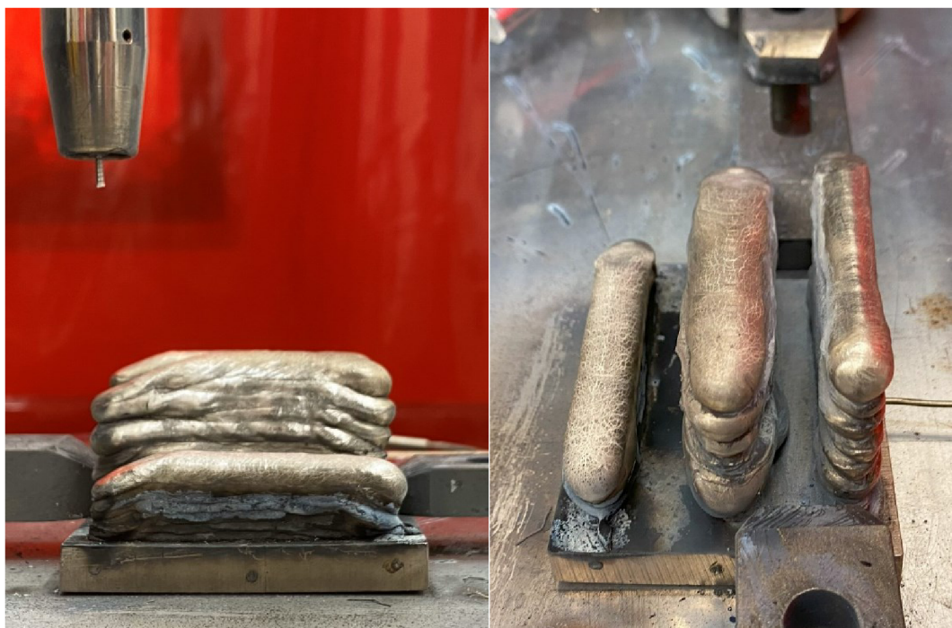
Obr. 8-2 Boční a horní pohled (vlevo) na tenkostěnný vzorek v průběhu výroby s předehřevem 200°C
