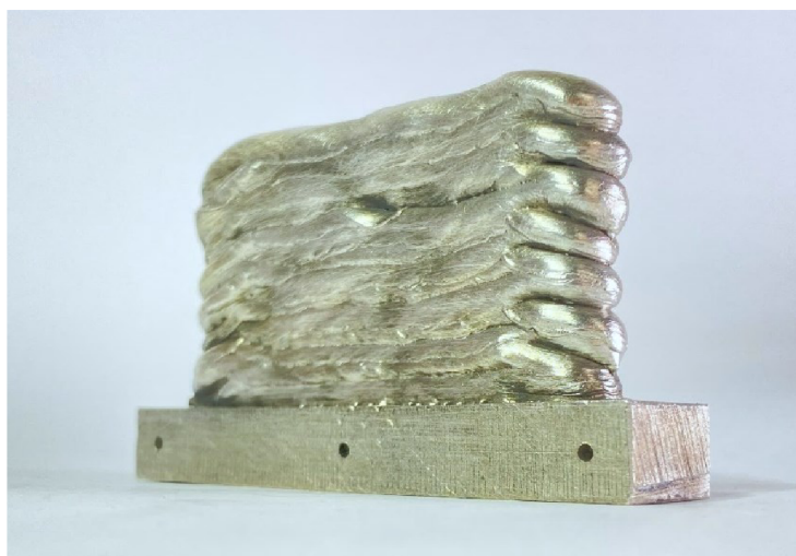
Obr. 7-22 Tenkostěnný vzorek vyrobený s částečným předehřevem
