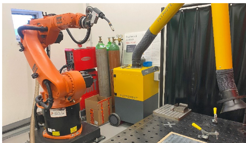
Obr. 6-2 Robotické rameno Kuka vybavené Svařovacím zdrojem Fronius
