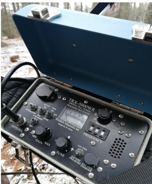
Obr. 8 a 9: Přístroj pro vyhledávání jelena metodou VHF a postup v terénu
