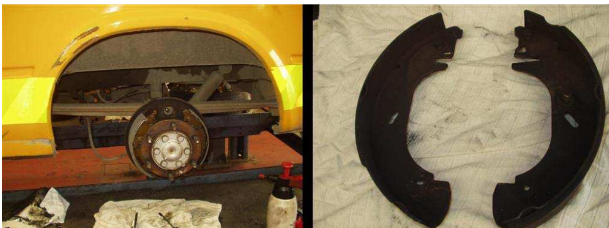
Obr. č. 10: Brzdové čelisti nákladního vozu obsahující azbest. (EVROPSKÁ KOMISE GŘ, 2006)
