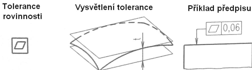
Obr. č. 2: Tolerance rovinnosti, převzato a upraveno z [2]str. 90
