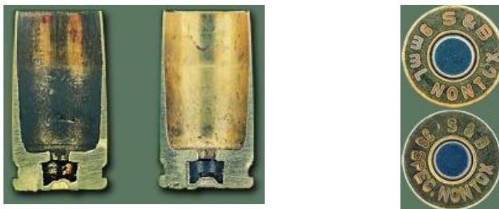
Obrázek 10: Průřez a spodek střeliva Nontox
