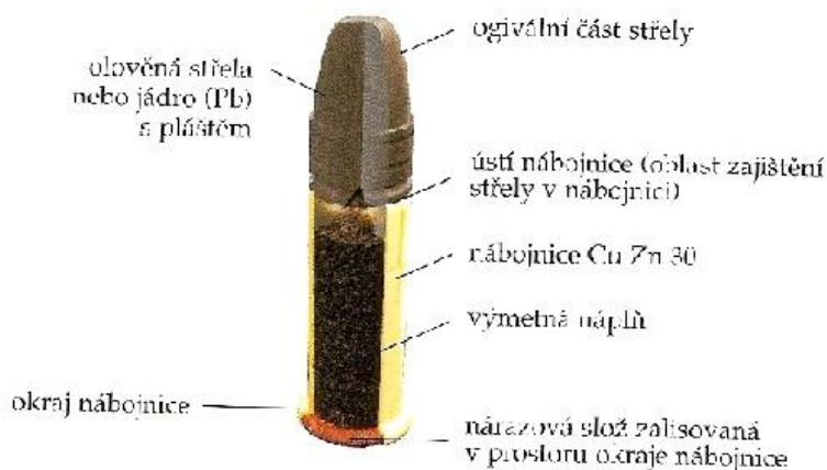
Obrázek 30: Konstrukce nábojů s okrajovým zápalem
