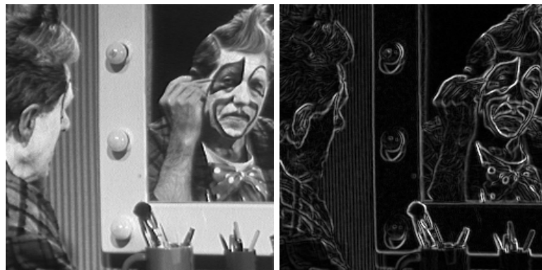
Obrázek 2.8: Sobelův hranový detektor. Vlevo se nachází původní obrázek, vpravo je výsledek po aplikaci Sobelova operátoru na detekci horizontálních a vertikálních hran. Převzato z [12].
