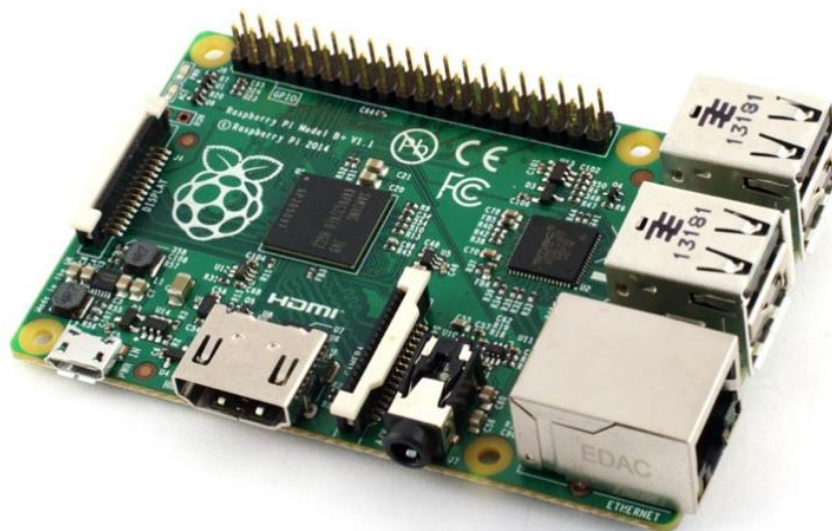
Obrázek 8 Raspberry Pi model B+ [33]
