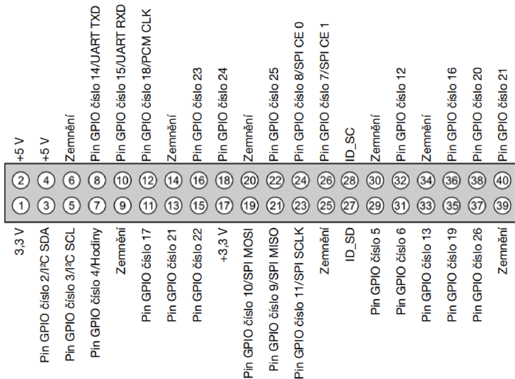
Obrázek 10 40pinový GPIO konektor [33]
