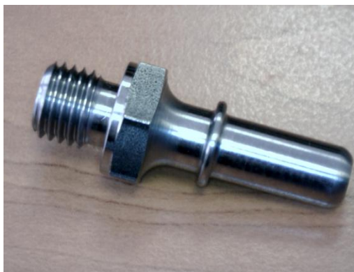
Obr. 3.1 Hotový výrobek FR-5327 Connector.
