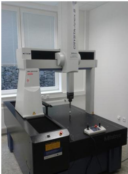
Obr. 1.6 Měřicí zařízení Mitutoyo CRYSTA-Apex S7106 [1].
