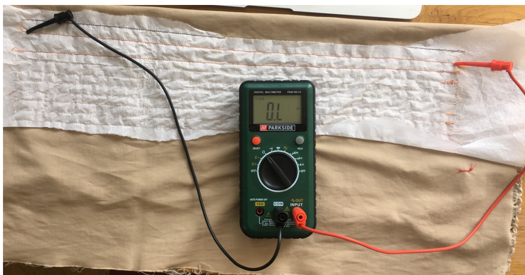
Obr. 25 Prístroj Parkside PDM 300 C2 a jeho pripojenie k vodivým dráham
