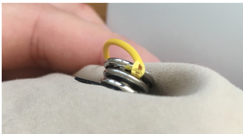
Obr. 36 Poškodené miesto káblíka, ktoré spôsobovalo prerušenie prenosu informácie v obvode
