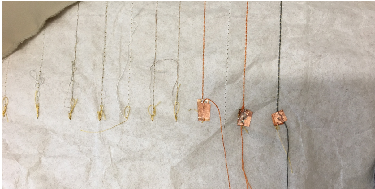
Obr. 26 Umiestnenie medeného pásika pre zlepšenie prenosu informácie
