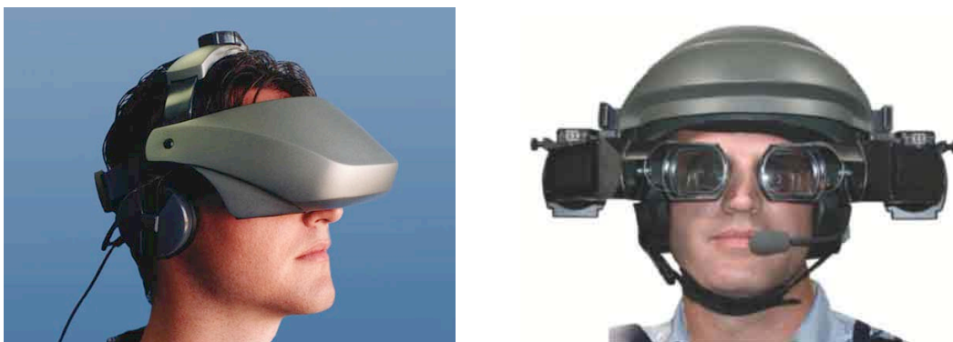
Obrázek 2.6: Vlevo video průhledový náhlavní displej, vpravo opticky průhledový [16, 17].
