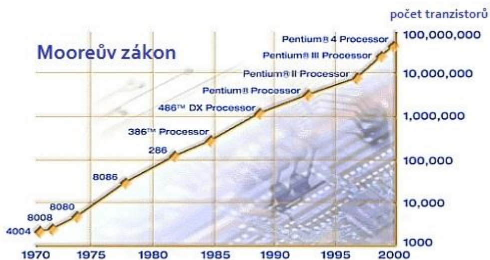
Obrázek 5: Mooreův zákon - počet tranzistorů na různých procesorech během času Zdroj: ANON. Svět hardware [online]. [cit. 4.12.2016]. Dostupné z: http://www.svehardware.cz/mooreuv-zakon-odhaluje-nejen-vyvoj-pocitacovych-cipu/40367 Poznámka: Uvedené pojmy v anglickém jazyce jsou názvy procesorů.
