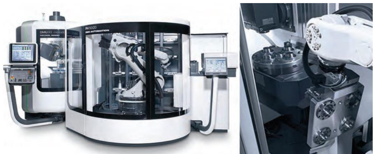
Obr. 7.6 Zásobník obrobků a stroj od firmy DMG [29]
