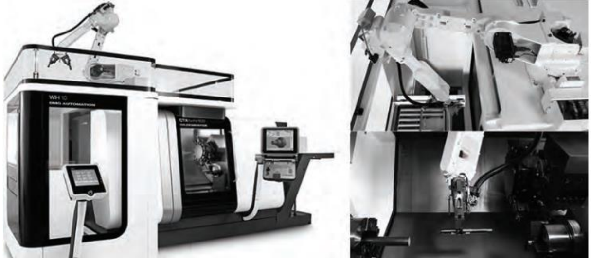
Obr. 7.5 Zásobník obrobků a stroj od firmy DMG [29]
