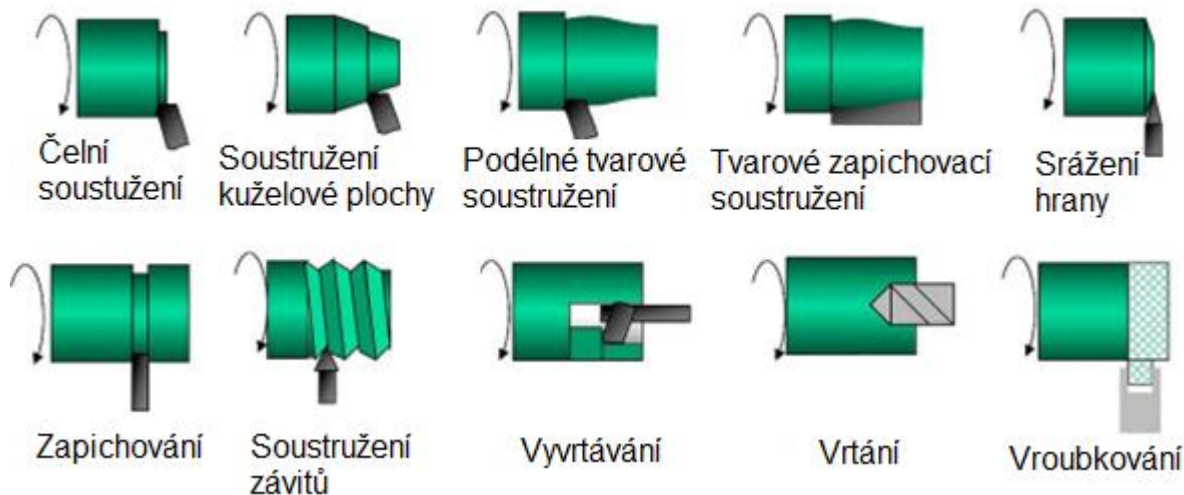
Obr. 4.1 Možnosti výroby na soustruzích [2]
