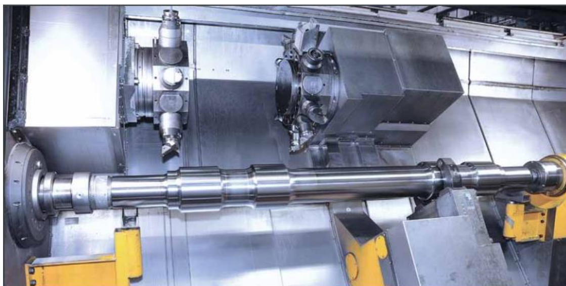
Obr. 5.14 Upnutý obrobek mezi hroty firmy KOVOSVIT MAS [32]
