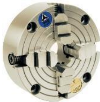
Obr. 5.7 Lícni desky s nezávisle přestavitelnými čelistmi [10]
