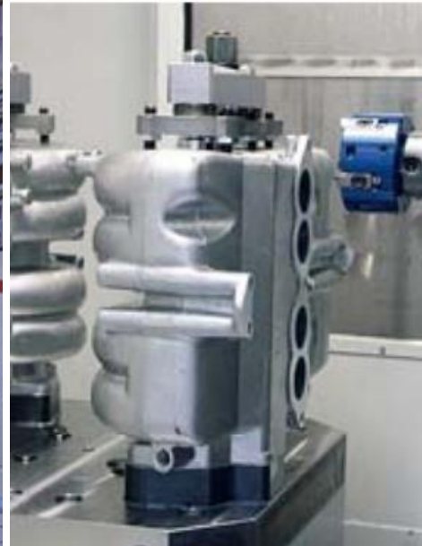
Obr. 8.9 Upnutý obrobek v H 500 [37]
