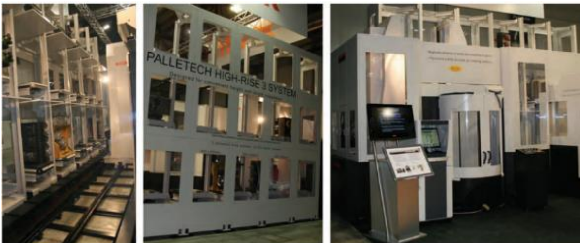
Obr. 7.8 Regálový skladový zásobník palet firmy MAZAK [26]
