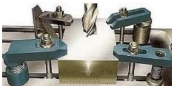
Obr. 4.29 Upínání pomocí upínek ke stolu stroje [19]
