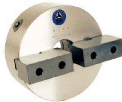
Obr. 5.2 Samostředící sklíčidlo IUM typu 060 se šesti čelistmi [10]
