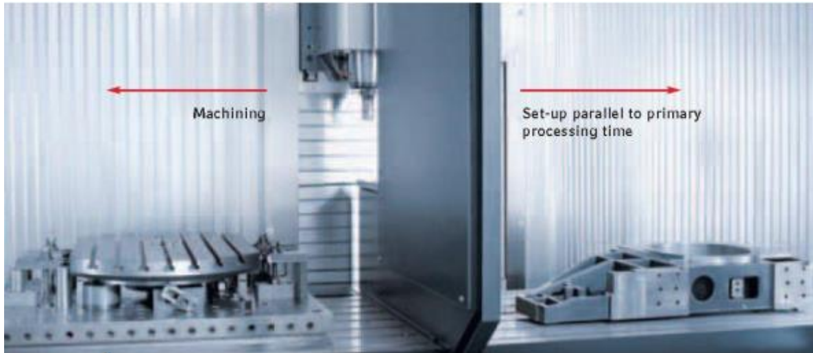
Obr. 7.7 Oddělené pracovní prostory od firmy DMG [29]
