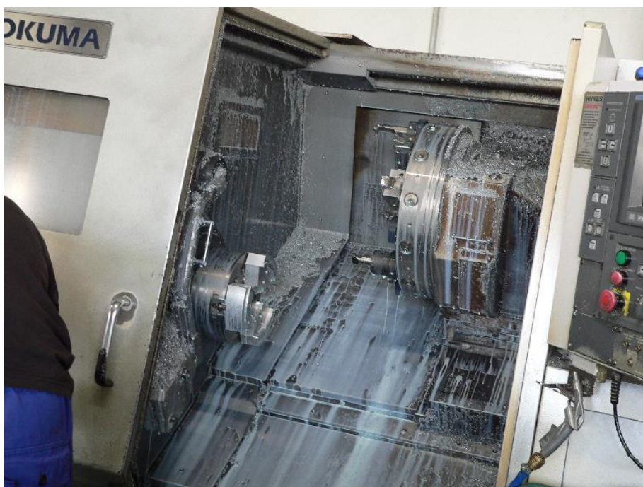
Obr. 8.3 Pracovní prostor v soustruhu LB3000M (OKUMA)
