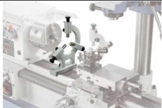
Obr. 4.11 Luneta na soustruhu [13]
