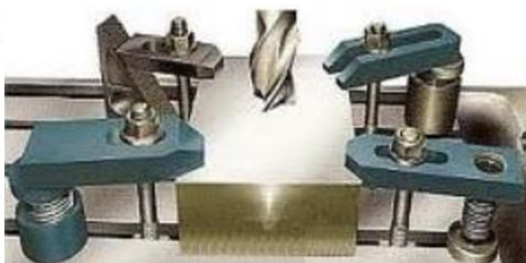
Obr. 4.29 Upínání pomocí upínek ke stolu stroje [19]
