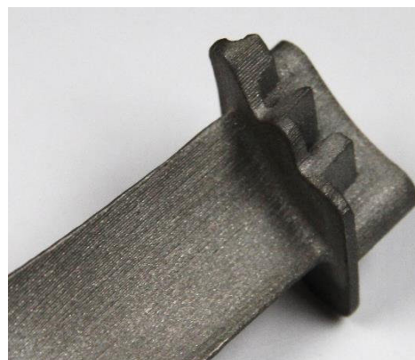
Obr. 28 Detail odlitku lopatky vyrobené na základě FDM modelu.
