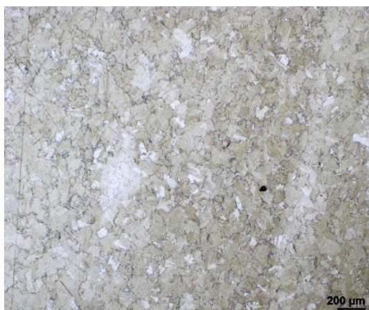
Obr. 62 Leptaný tisknutý materiál IN 939 (HIP-P, 60 μm), (E) zvětšeno 50x.
