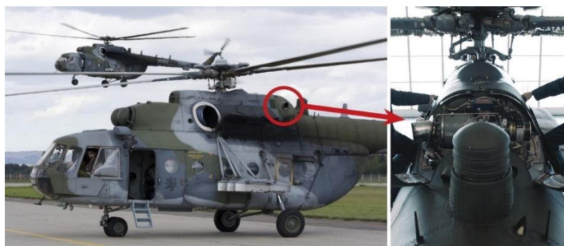
Obr. 9 Zástavba PEJ Safir 5K/G MI ve vrtulníku MI 8/17 podle [2; 11].
