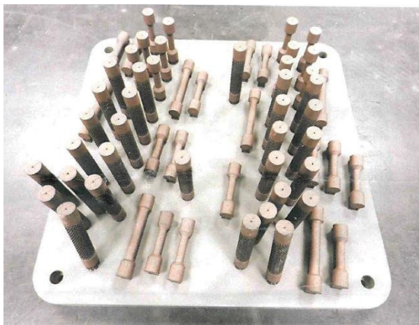
Obr. 35 Rozložení modelů s 60 \mu\text{m} výškou vrstvy na tiskové platformě.
