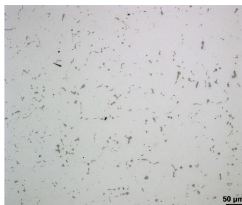
Obr. 50 Leštěný litý materiál IN 939 (HT-C) (B) zvětšeno 200x.
