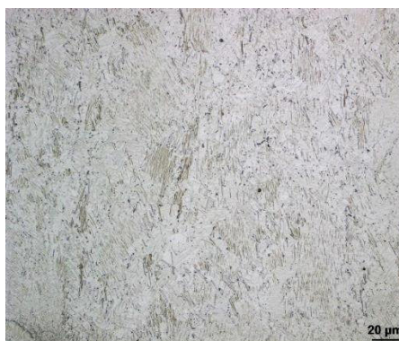
Obr. 61 Leptaný tisknutý materiál IN 939 (HT-P, 30 μm), (D) zvětšeno 500x.
