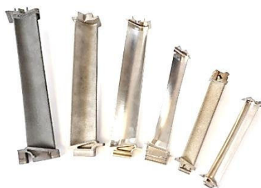
Obr. 15 Turbínové lopatky největšího proudového motoru na světě GE9X společnosti General Electric [18].
