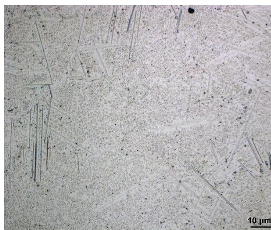
Obr. 65 Leptaný tisknutý materiál IN 939 (HIP-P, 60 μm), (E) zvětšeno 1000x.
