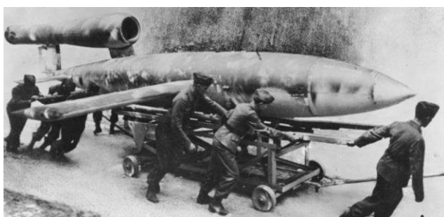
Obr. 5 Využití proudového pulzačního motoru pro pohon raket V1 v druhé světové válce [4].
