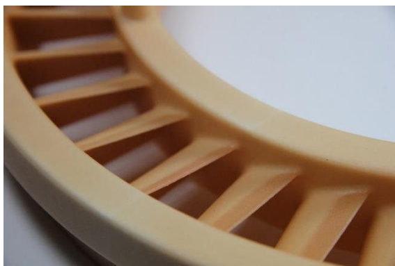
Obr. 24 Model produktu určený ke zpracování technologií přesného lití vyrobený metodou Binder Jetting.
