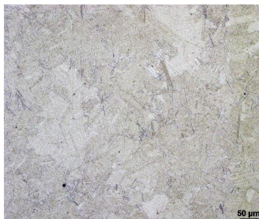
Obr. 63 Leptaný tisknutý materiál IN 939 (HIP-P, 60 μm), (E) zvětšeno 200x.
