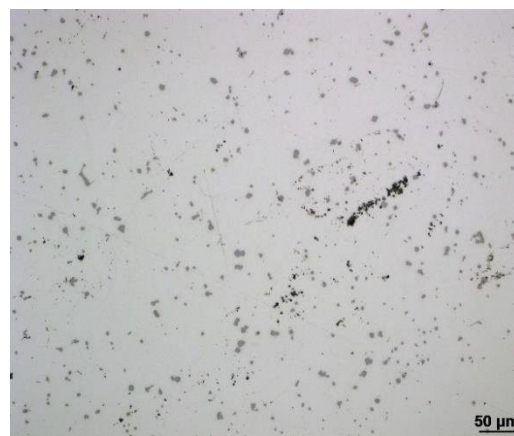
Obr. 54 Leštěný litý materiál IN 939 (HIP-C) (C) zvětšené 200x.
