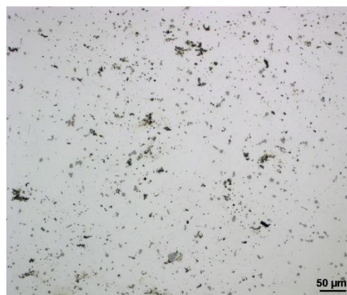
Obr. 48 Leštěný litý materiál IN 939 bez TZ (A) zvětšeno 200x.
