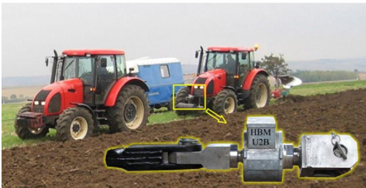
Obr. 43: Referenční měření soupravy pro validaci měřícího zařízení.
