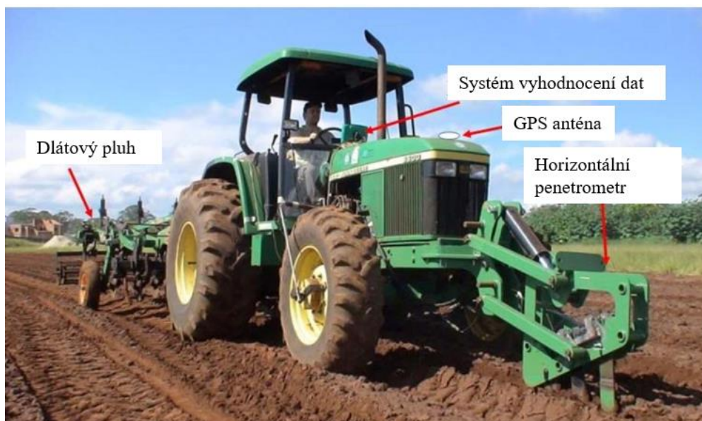
Obr. 15: Sestava zkušebního zařízení pro automatické nastavení pracovní hloubky implementu podle hloubky plužní pánve.
