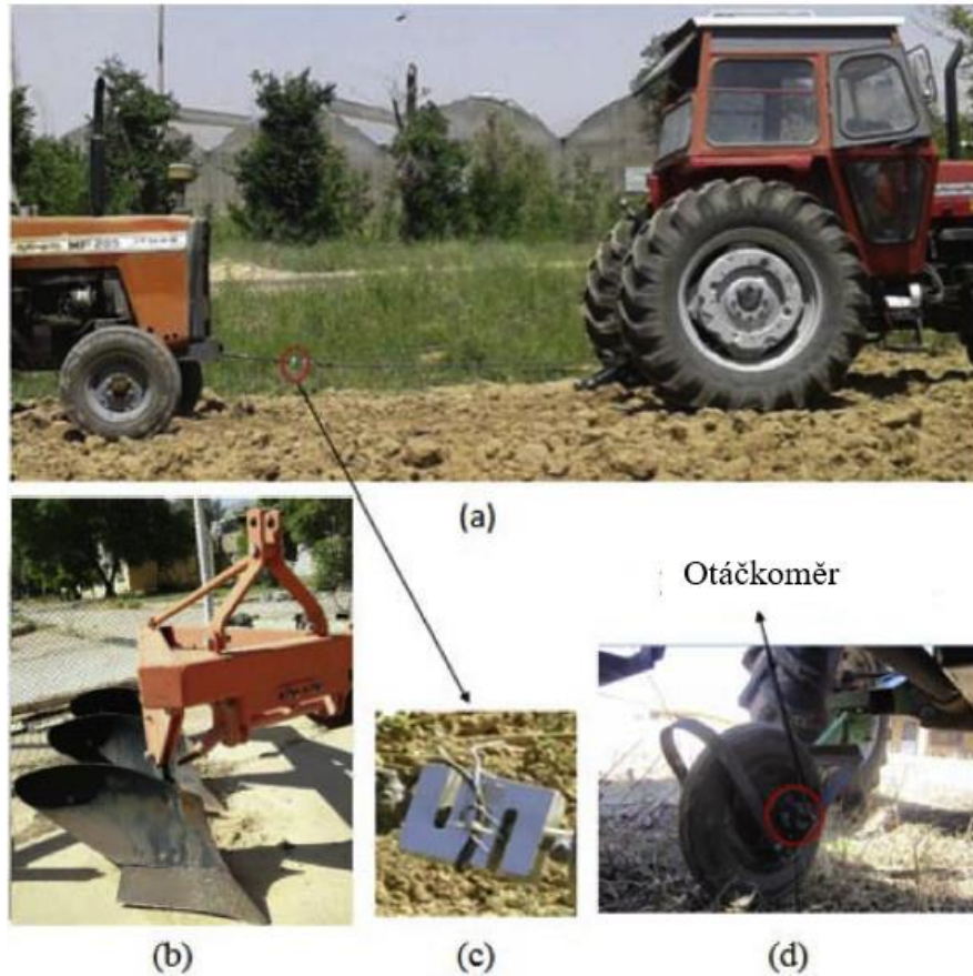
Obr. 31: Měření tahové síly soupravy. (a) umístění tenzometru, (b) použitý pluh, (c) detail tenzometru, (d) kolo snímající rychlost
