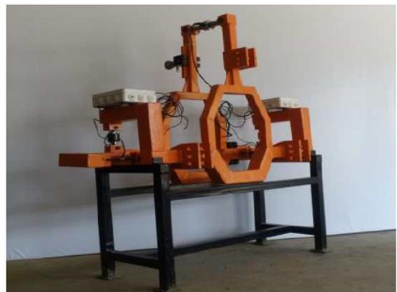
Obr. 56: Měřicí zařízení. 1 – laterální tenzometry, 2 – vertikální tenzometry, 3 – horizontální tenzometry, 4 – traktorový rám, 5 – rám implementu
