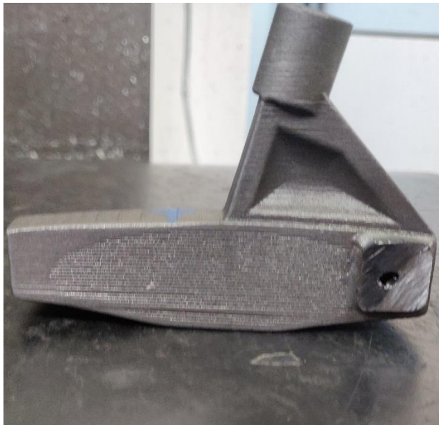
Obr. 32 Odlitek s odřezanou vtokovou soustavou
