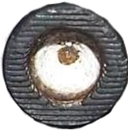
Obr. 39 Výronek v díře pro shaft
