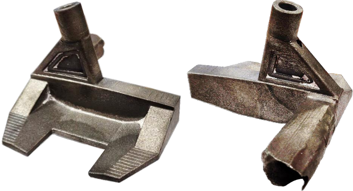
Obr. 31 Odlitek tryskaný broky
