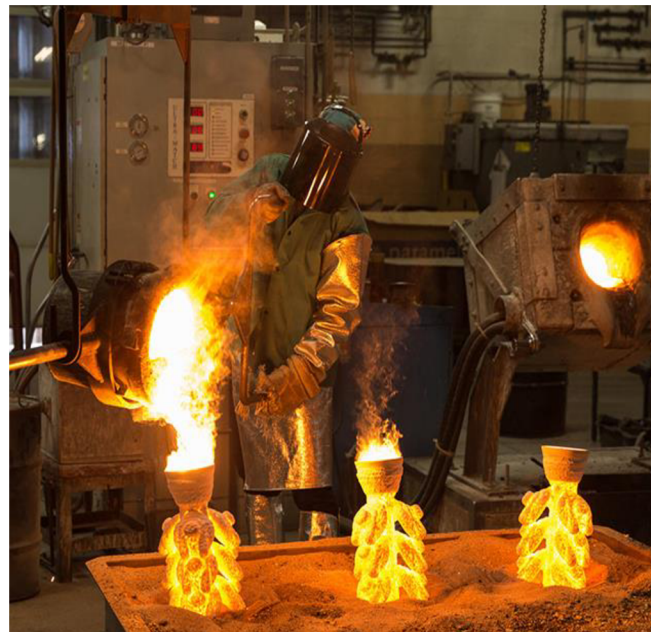
Obr. 29 Skořepiny během odlévání [29]
