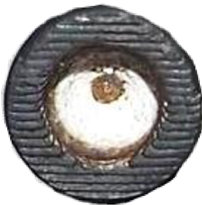
Obr. 39 Výronek v díře pro shaft
