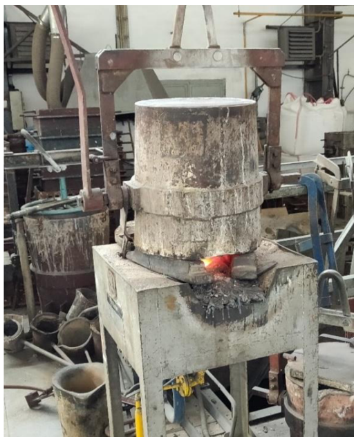
Obr. 28 Předehřívání lící pánve
