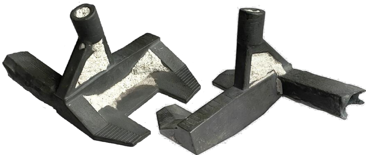
Obr. 30 Odlitek po vytlučení
