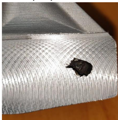
Obr. 38 Staženina na odlitku č. 2
