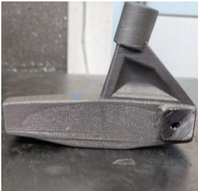
Obr. 32 Odlitek s odřezanou vtokovou soustavou
