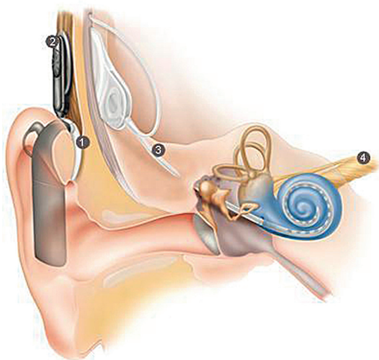
Obr. č. 1, Řez sluchovým orgánem s kochleárním implantátem. 1 zvukový procesor, 2 cívka, 3 vnitřní část implantátu/přijímač, 4 sluchová nervová vlákna
