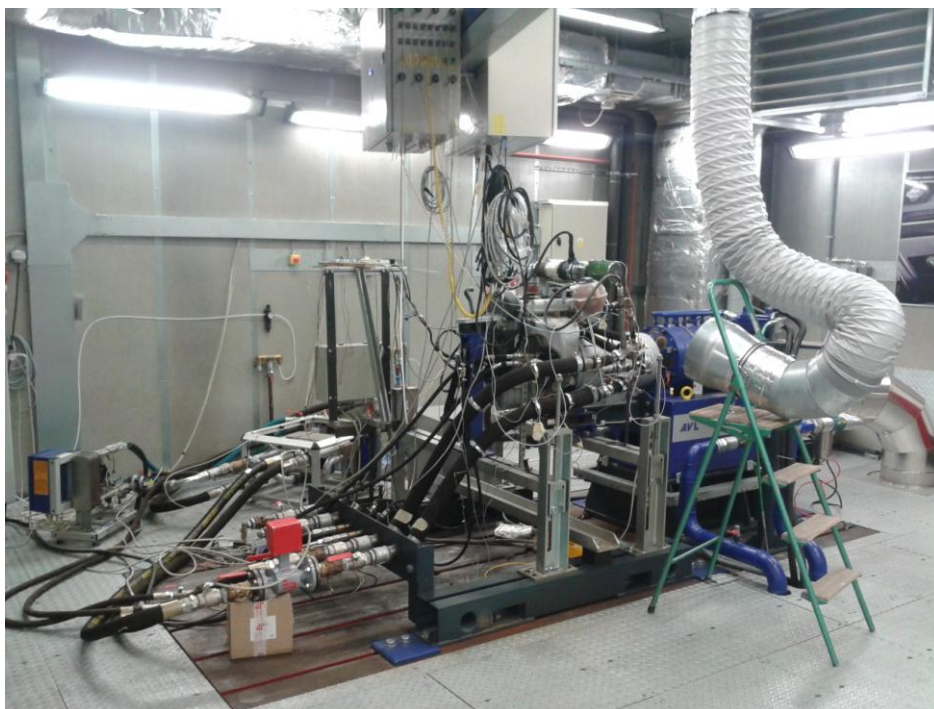
Obr. 8 – Umístění motoru a dynamometru na motorové zkušebně (Autor, 2015)
