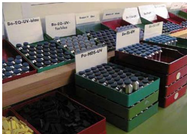
Obr. 2 - Materiály na výrobu RGP čoček [11]
