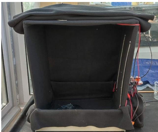
Obrázek 6. Fenotypizační box. Do posuvného držáku byl dán hydroponický košíček s bazalkou. Přední strana byla během focení překryta černým flísem, aby bylo zajištěno co nejtmaší pozadí fotografie.
