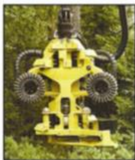
Obr. 9 Harvestorová hlavice švédského typu John Deere H752 (URL 7, 2016)
