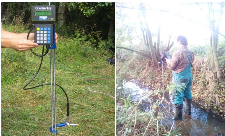
Obr. č. 7: Měření průtoku vody - přístroj Flow tracker
