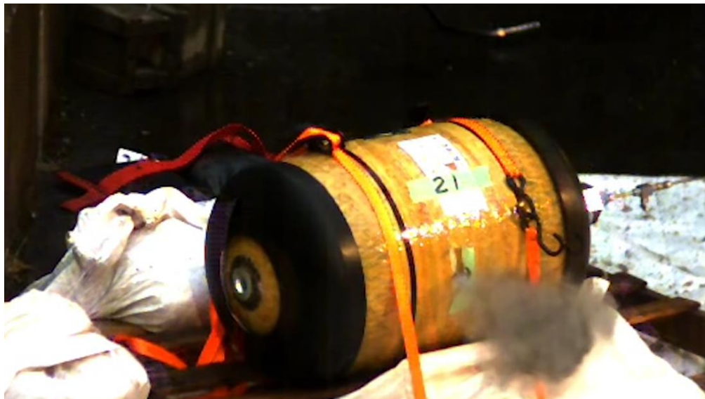
Obr. 7 Experiment prostřelení vodíkové nádrže firmy Toyota [38]
