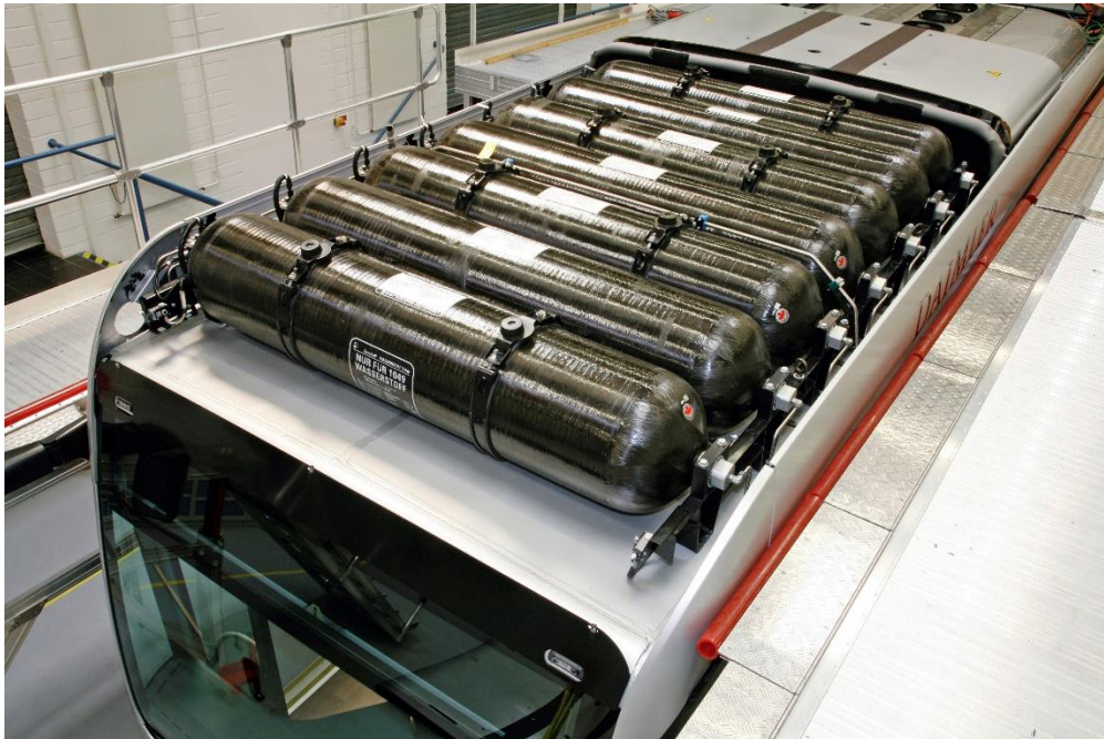
Obr. 9 Vodíkové nádrže autobusu Mercedes-Benz Citaro FuelCELL-Hybrid [41]
