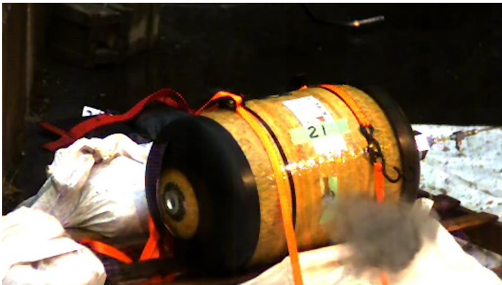
Obr. 7 Experiment prostřelení vodíkové nádrže firmy Toyota [38]
