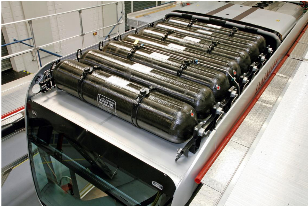
Obr. 9 Vodíkové nádrže autobusu Mercedes-Benz Citaro FuelCELL-Hybrid [41]
