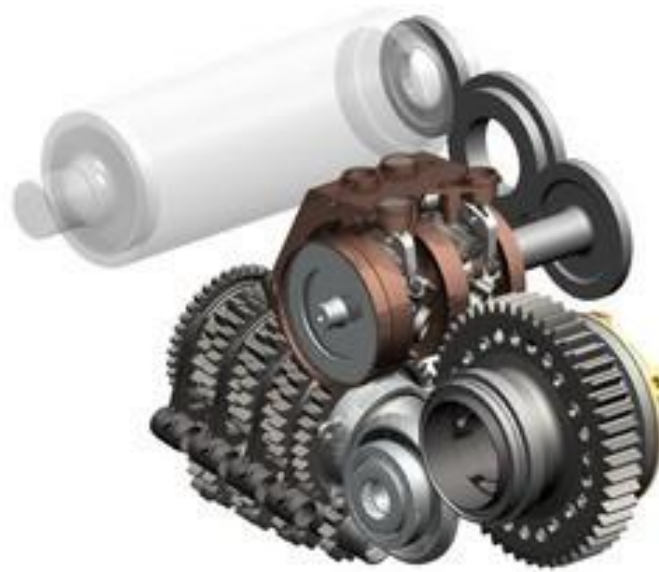
Obr. č. 7: CVT Toroidní převod připravovaný pro F1, [7]
