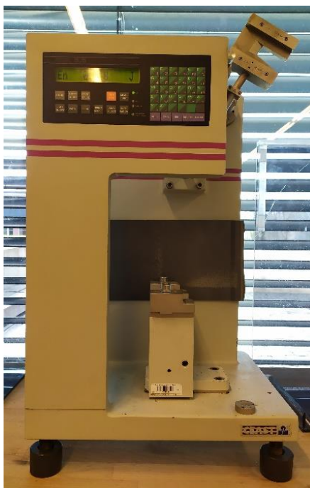
Obr. 3.31 Zkušební zařízení Resil Ceast 5.5 pro stanovení rázové houževnatosti Charpy
