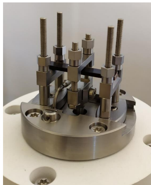
Obr. 3.32 Analyzátor DMA 1 Mettler Toledo (vlevo) a princip upnutí zkušebních těles vpravo
