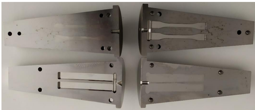
Obr. 3.9 Vstřikovací formy pro výrobu zkušebních těles ve tvaru hranolu o rozměrech 80 x 10 x 4 mm (vlevo) a typu 1BA dle normy ISO 527 (vpravo)
