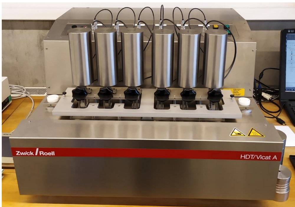
Obr. 3.28 Zařízení HDT/Vicat A od firmy Zwick/Roell pro měření teploty měknutí dle Vicata
