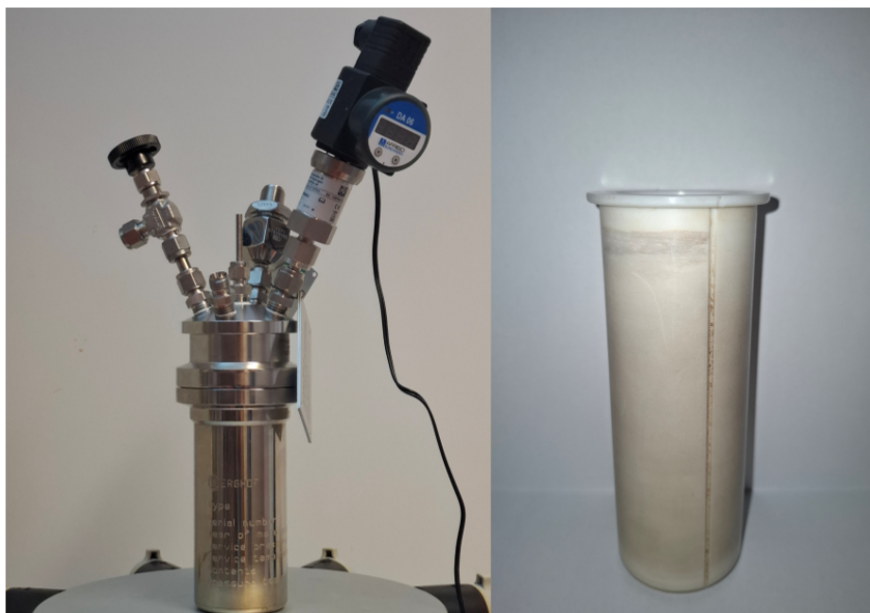
Obrázek 2.2: Fotografie hydrotermálního reaktoru s linerem použitého při syntézách částic za zvýšeného tlaku a teploty
