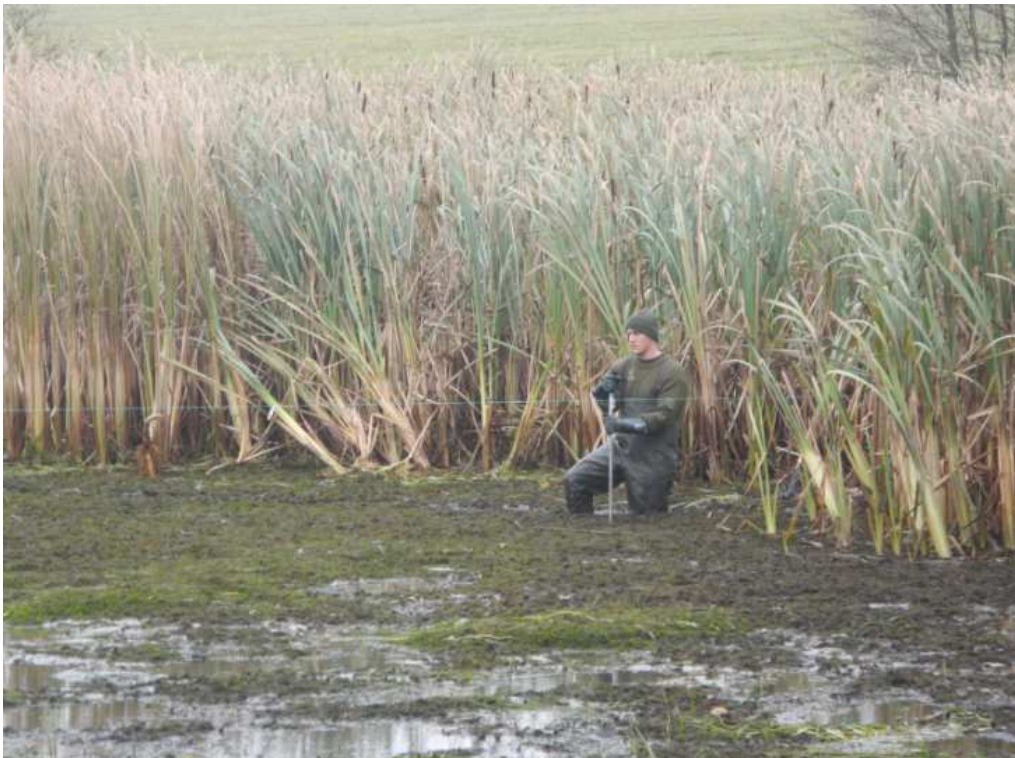
Obrázek 9. Měření sedimentu pomocí sondovací tyče (autor)
