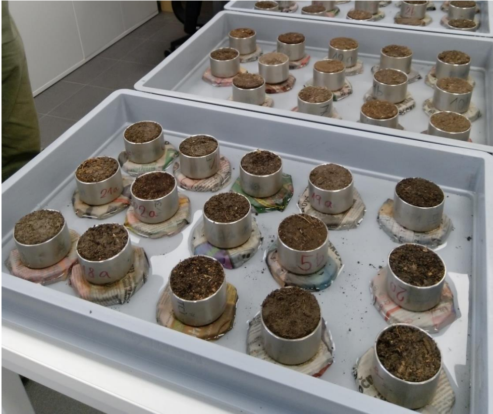
Obr. 13: Kopeckého válečky ve vodní lázni
