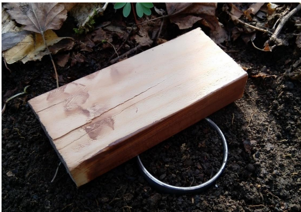
Obr. 11: Odběr půdního vzorku do Kopeckého válečku
