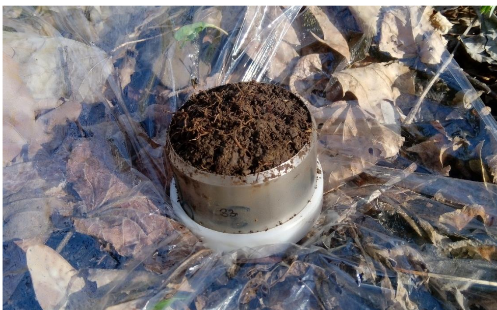
Obr. 12: Odebraný půdní vzorek do Kopeckého válečku
