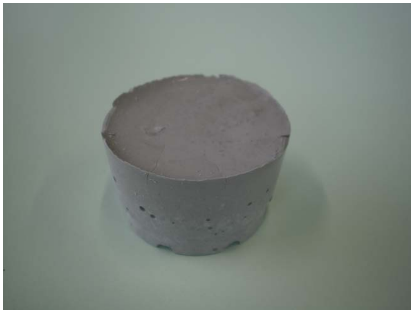
Obr. č. 22: Vzorek č. 2 čtvrté série – průměr vzorku = 3,5 cm.
