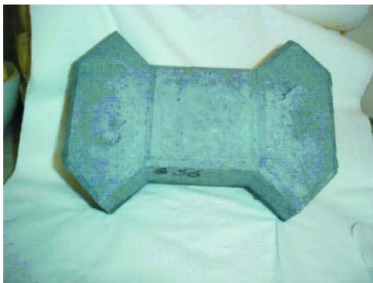
Obr. č. 6: Vzorek zámkové dlažby zhotovený z geopolymerního betonu [4].
