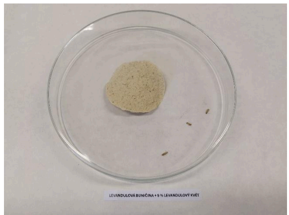
Obrázek 27 Levandulová buničina + 5 % levandulového květu
