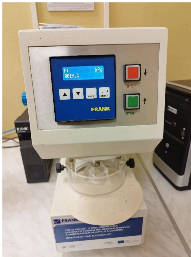
Obrázek 20 Zařízení pro stanovení pevnosti v průtlaku
