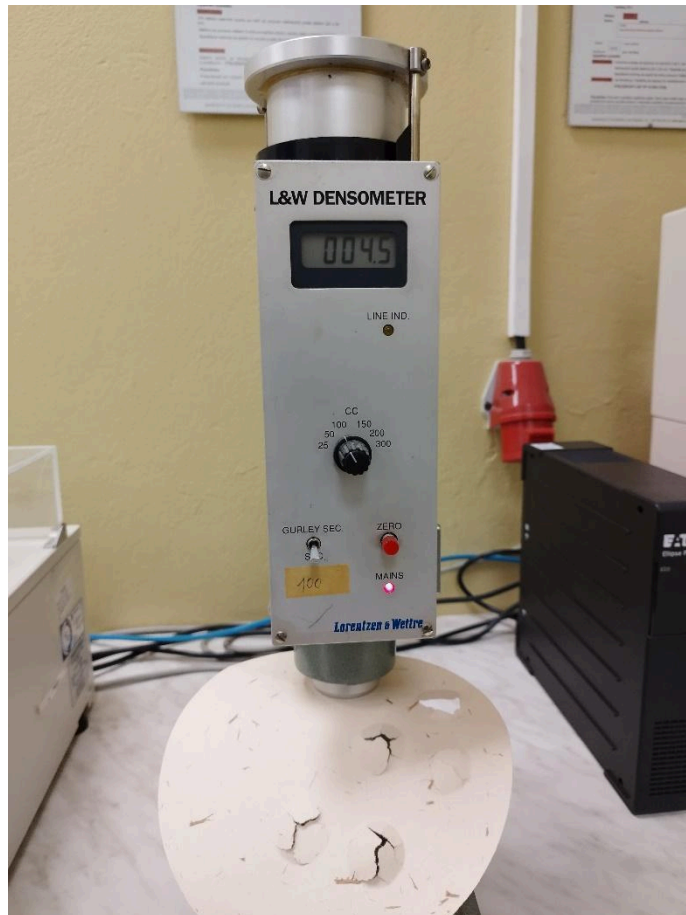
Obrázek 21 Zařízení pro stanovení propustnosti pro vzduch
