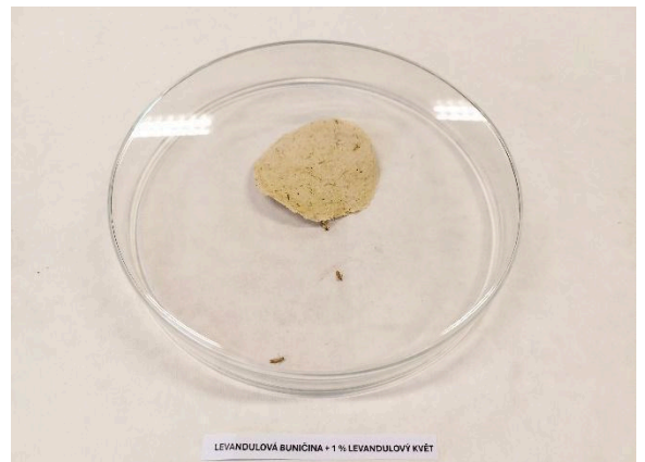
Obrázek 25 Levandulová buničina + 1 % levandulového květu
