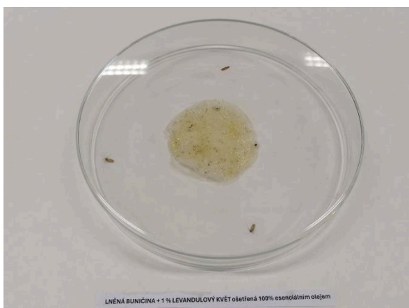
Obrázek 36 Lněná buničina s 1 % levandulového květu a 100% olejem
