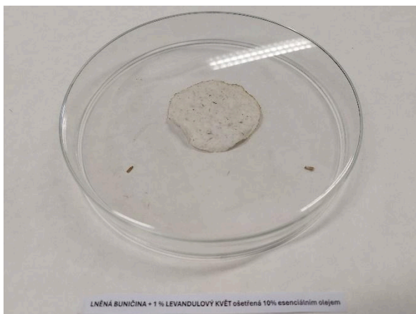
Obrázek 30 Lněná buničina s 1 % levandulového květu a 10% olejem
