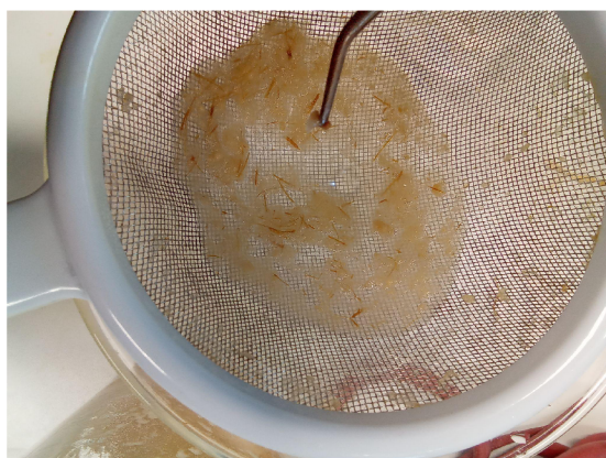
Obrázek 3 Vyjímání neprovarů z buničiny
