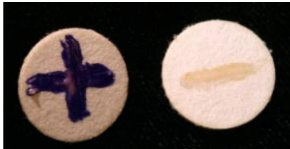
Obr. č. 6: Pozitivní a negativní výsledek reakce oxidázového testu (Mittal, 2017)
